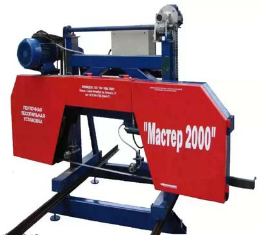
Рисунок 6.17 – Деревообрабатывающие станки для распила бревен и досок: а – однодисковая установка для распиловки бревен; б – ленточная пилорама
