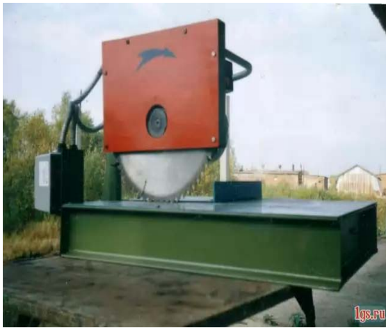
Рисунок 6.17 – Деревообрабатывающие станки для распила бревен и досок: а – однодисковая установка для распиловки бревен; б – ленточная пилорама
